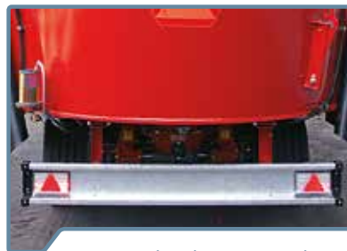
Beleuchtungseinrichtung mit Anfahrtschutz
