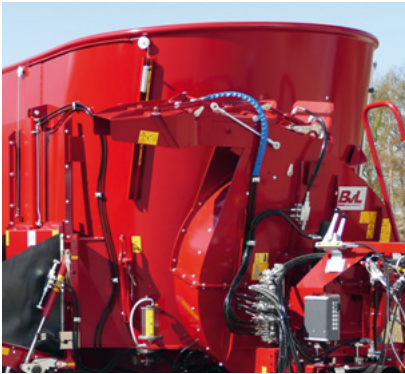
DIREKTAUSWURF Einfacher direkter Auswurf für eine große Wurfweite.
