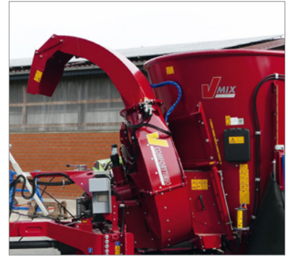
DREHBARER, STARRER TURM Drehbarer, hoher Auswurf für eine große Wurfweite und Einstreuen direkt hinter dem Fressgitter.
