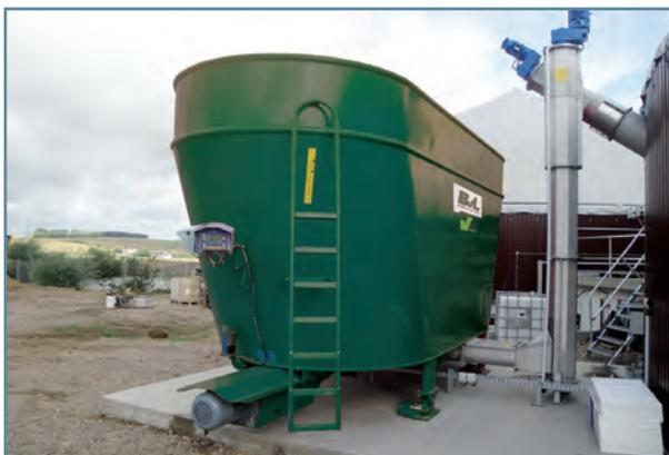
Schneckenförderstrang zum Befüllen eines Hochfermenters
