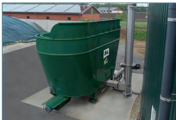
Überwurfschutz für Feststoffdosierer
