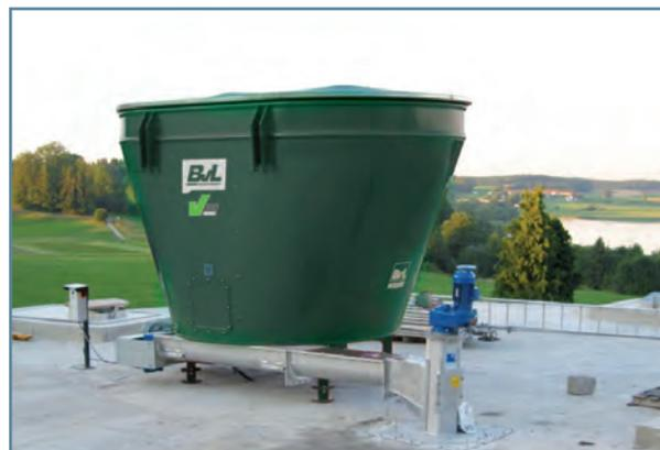
Schneckenförderstrang zum Befüllen eines Erdfermenters
