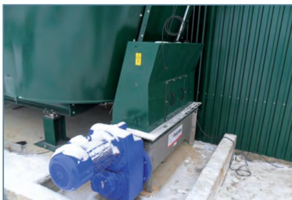
Frontaustrag zum Befüllen einer Flüssigfütterung
