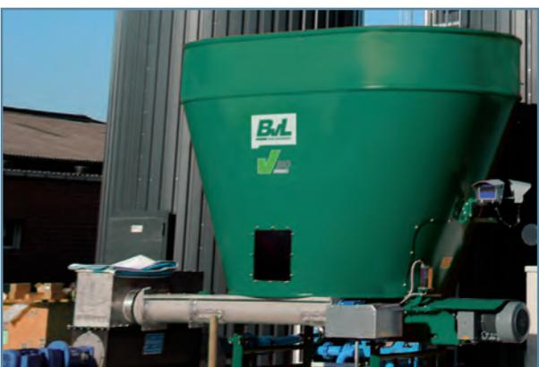
Unterbauschnecke zum Befüllen einer Flüssigfütterung
