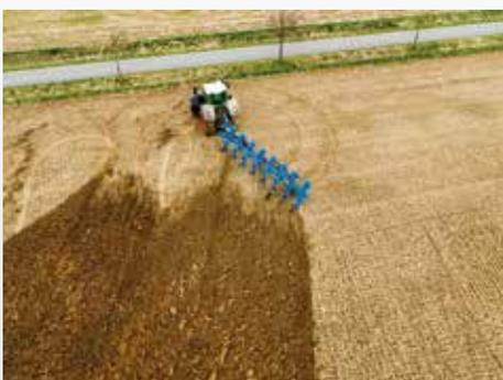
Der große Freiraum zwischen Pflug-turm und Traktor sichert den Einschlag bis 90°. Durch den Drehvorgang des Pfluges wird das Aufsattelrad
