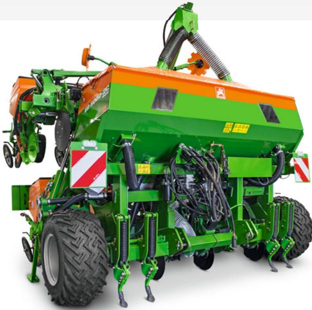
❗ „Durch die Sichtfenster im Düngertank hat der Bediener den Füllstand gut im Blick.“
