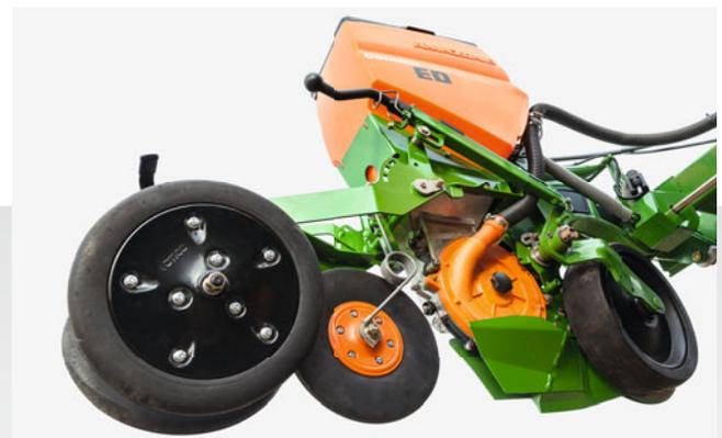
Säaggregate Contour mit zusätzlicher Saatandruckrolle
