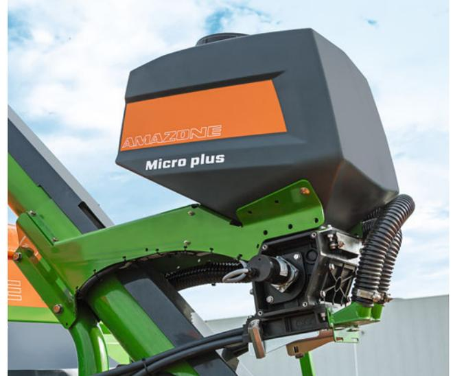
Die ISOBUS-Terminals aus der Profi-Elektronikausrüstung sind in der Lage einen Mikrogranulatstreuer selbstständig zu steuern. Ein zweiter Mikrogranulatstreuer muss über einen zusätzlichen AmaDrill+ gesteuert werden.
