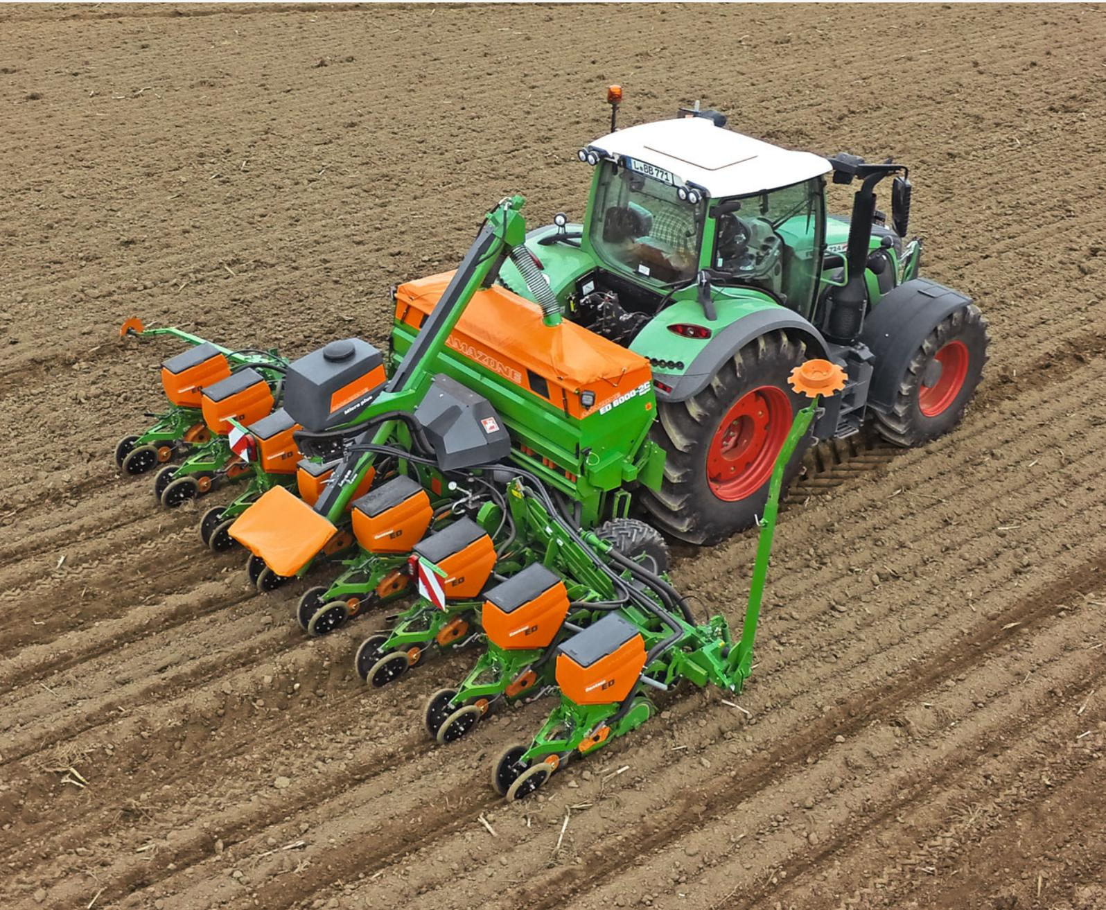
Einzelkorn-Sämaschine ED 6000-2C Super
