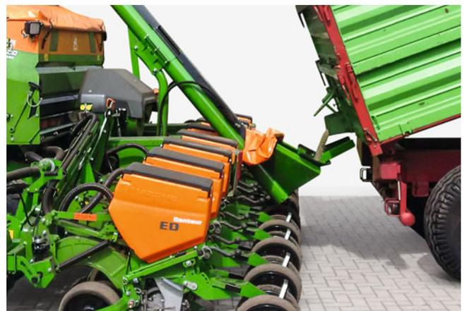
Befüllschnecke mit Befüllhilfe
