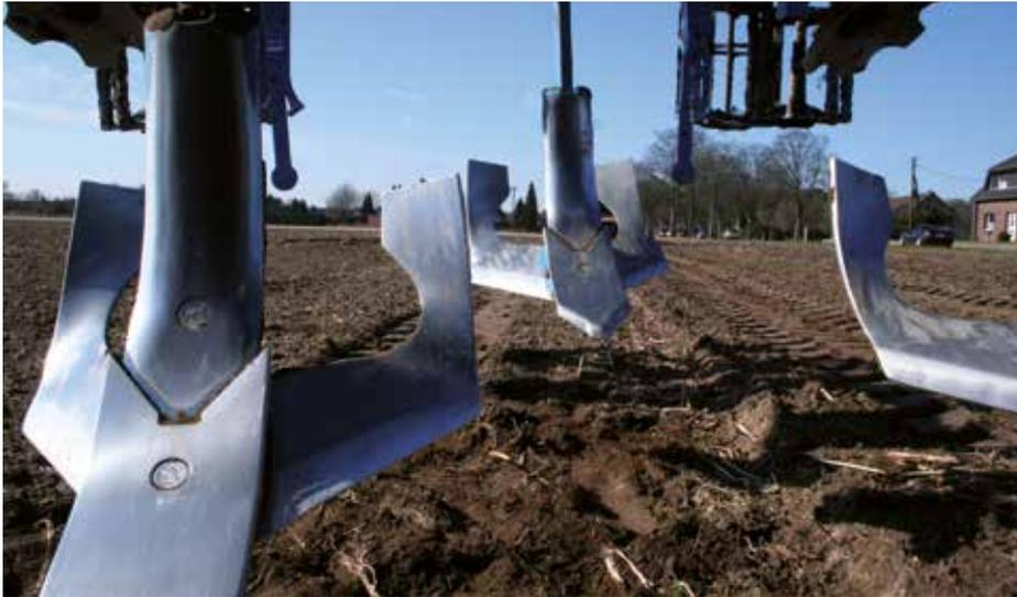
Mit dem Kompakt-Grubber Kristall von LEMKEN kann in mehreren Stufen sowohl flach als auch mitteltief gearbeitet werden. Bei flacher Bearbeitung im ersten Arbeitsgang arbeiten die speziell geformten TriMix-Flügelschare Ausfallgetreide und organische Masse ganzflächig und oberflächennah in den Boden ein. Das Ausfallgetreide verbleibt in der oberen Bodenschicht und kann kurzfristig keimen.
