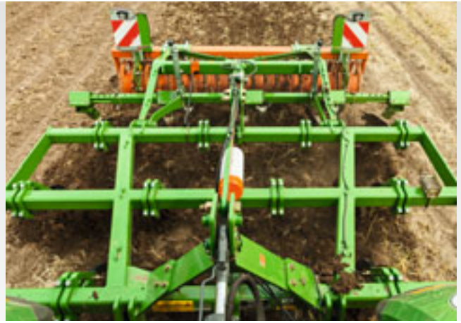
3-balkiger Rahmenaufbau des Cenius 3003 Special
