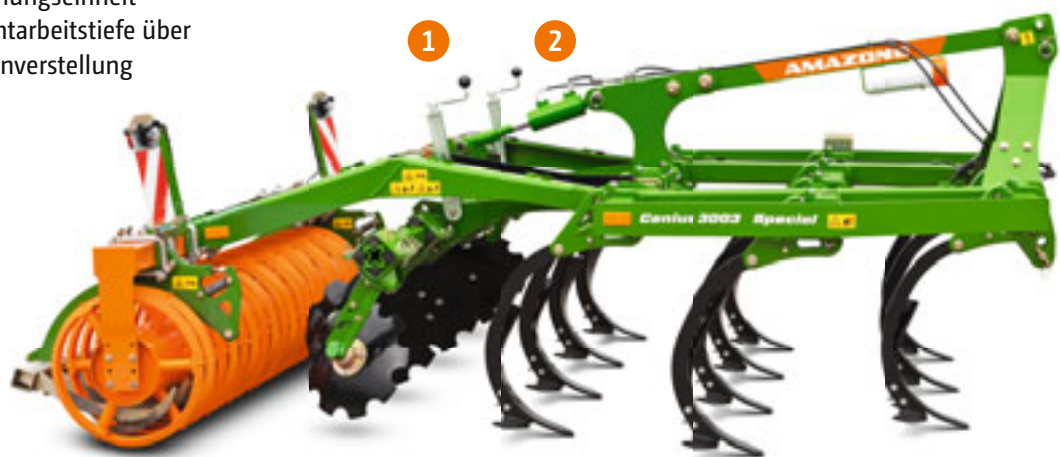
Cenius Special: C-Mix-Zinken mit Scherbolzen-Überlastsicherung und Winkelprofilwalze
