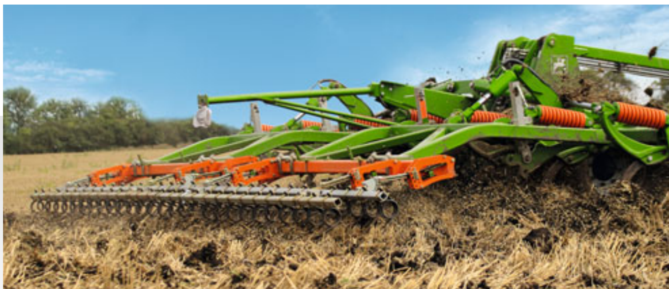
Doppelstriegel bei der flachen Bearbeitung
