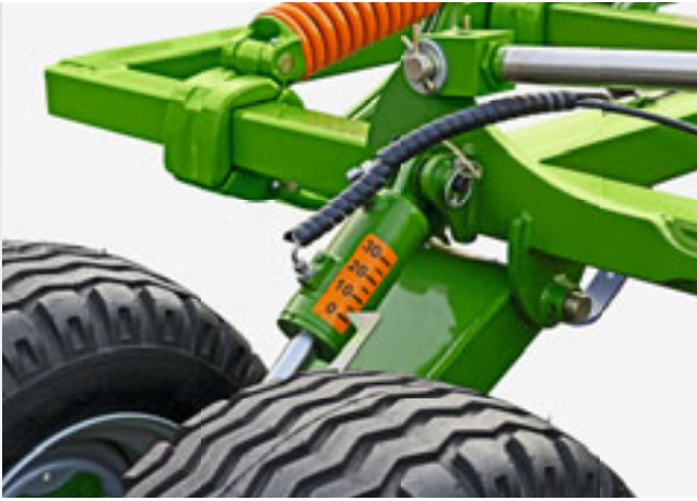
Skala der hydraulischen Arbeitstiefenverstellung des Zinkenfeldes
