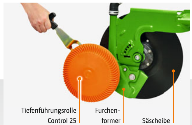
✓ RoTeC pro-Schar mit Tiefenführungsrolle Control 25 Die rückwärtig geöffneten Lamellen sorgen für eine sehr gute Eigenreinigung.
