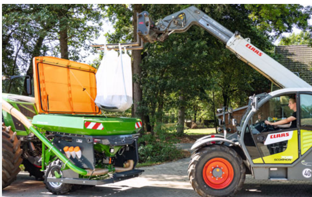
Große Behälteröffnung von 1,10 m x 2,20 m zur schnellen und einfachen Befüllung des FTender
