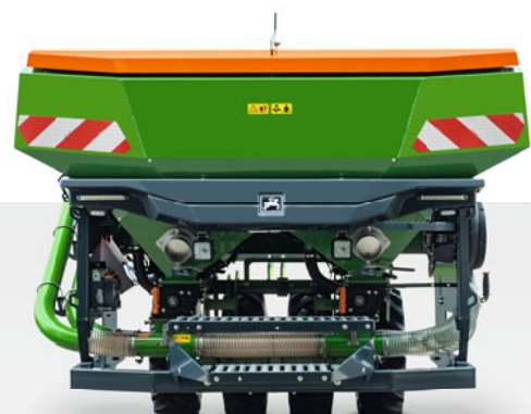
FTender 2200-C mit geteiltem Behälter für die Kombination von Saatgut und Dünger oder ein zweites Saatgut
