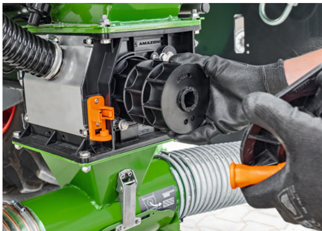
Einfacher Wechsel der Dosierwalze beim FTender
