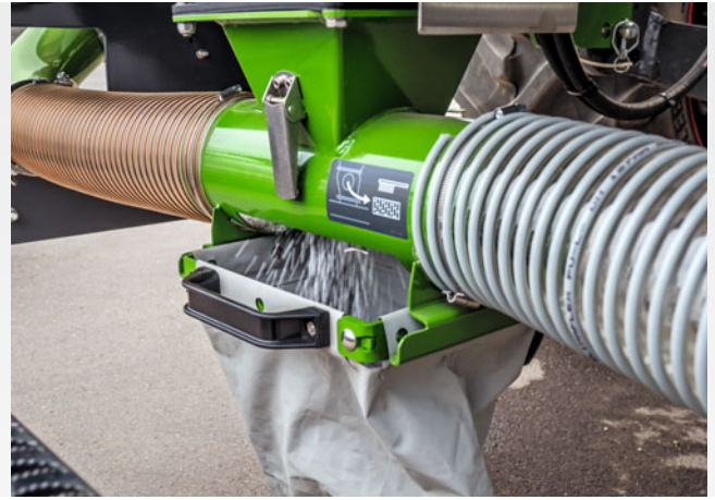
Der Kalibriersack kann komfortabel unterhalb des Dosierers eingehängt werden
