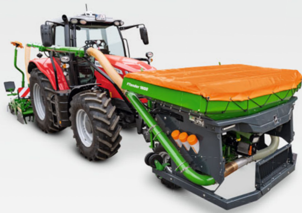
FTender 1600 mit offenem Fördersystem mit Abdeckplane
