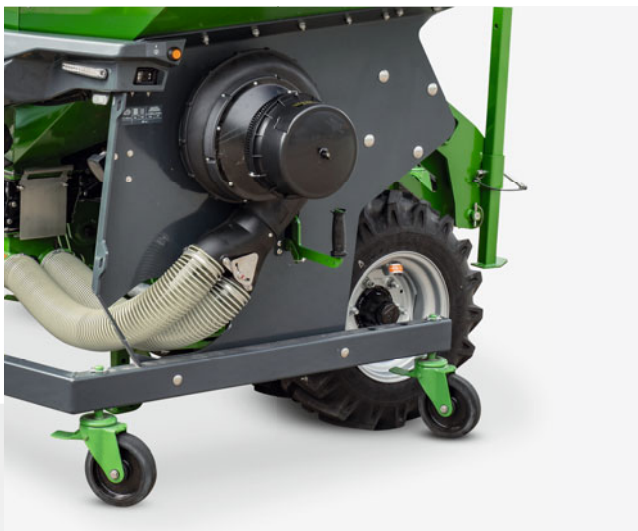
FTender mit Frontreifenpacker T-Pack F mit optionalen Abstellrollen und optionalem Staubabscheider
