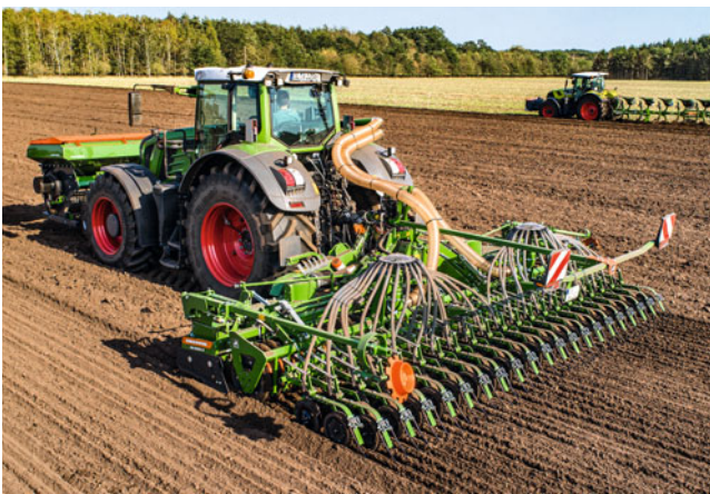
Klappbarer KG 6002-2 mit 6 m Arbeitsbreite und aufgebauter Avant-Säeinheit mit TwinTeC-Scharen
